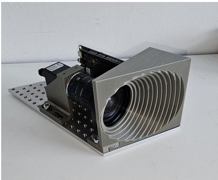
Koncept spektrální kamery VESNA s prototypem průzoru, který bude umístěn pod úhlem 27° na spodní straně každého ze dvojice satelitů SLAVIA tak, aby byl při pozorování z výšky 650 km zajištěn překryv zorných polí za účelem triangulace dráhy meteoru. Tento údaj doplní prvkovou analýzu a odhalí, odkud ve Sluneční soustavě pozorované těleso pochází.
